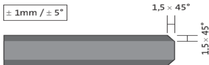
Obr.4: Ukážka opracovania hrany do tvaru T
